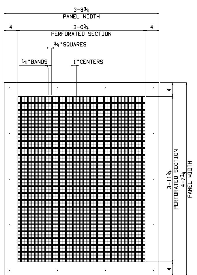
ONE GRILLE PANEL 25P2 RIGHT SIDE (LOOKING AT STAGE FROM SEATS) MATERIALTHICKNESS: 12 GAUGE
