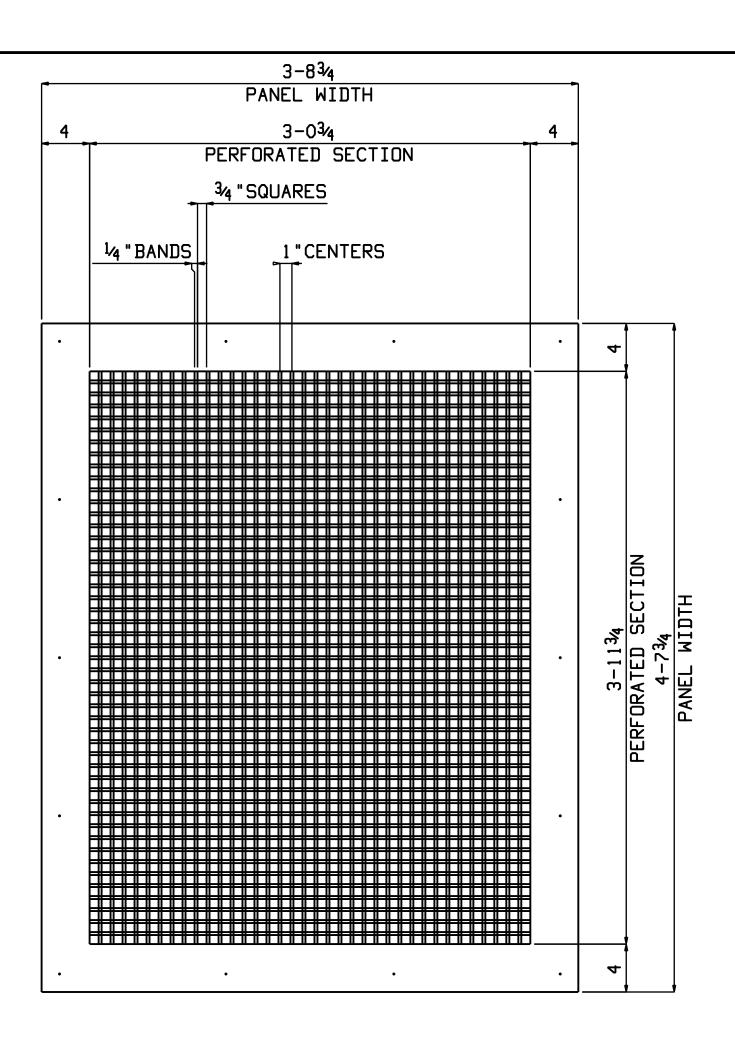
ONE GRILLE PANEL 25P1 LEFT SIDE (LOOKING AT STAGE FROM SEATS) MATERIALTHICKNESS: 12 GAUGE
